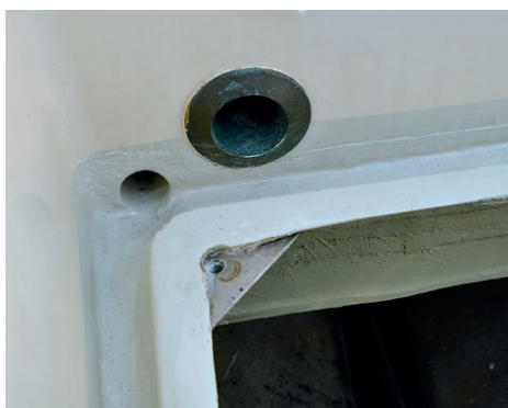
T.v. nya utloppet för självlänsen och t.h. "katastrof-utloppet" W
