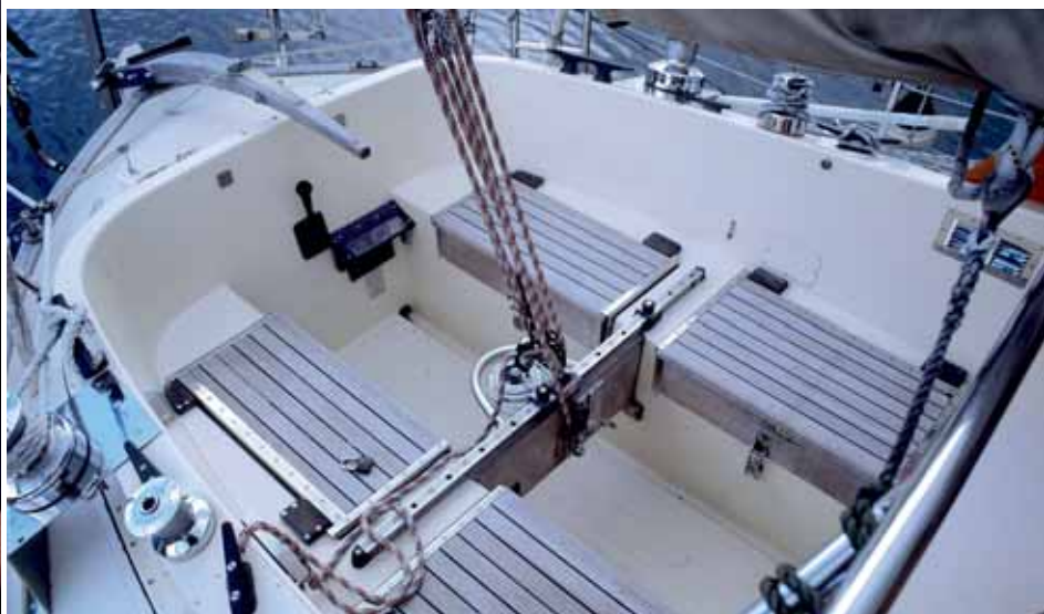
△ En väl skyddad och dränerad sittbrunn. Luckorna är extra förstärkta för att försvåra inbrott.
